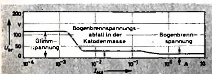
Bild 1. Strom-Spannungs-Kennlinie einer „BT-Arcotron“-Röhre mit Glüh- und Bogenentladung; U_0 Bogenbrennspannung, I_{HA} Hilfsanodenstrom
